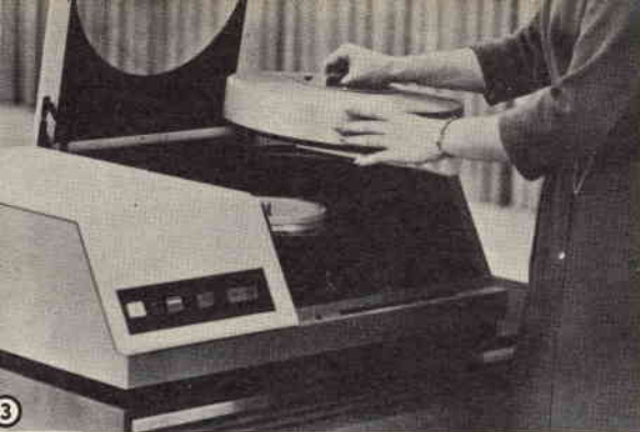
Nei particolari 3 e 4 sono illustrate le ultime due operazioni di inserimento. I Dispac possono essere altrettanto facilmente rimossi ed archiviati, come se si trattasse dei libri di una biblioteca.
